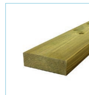
Magatello in larice impregnato dimensioni 30x75x2000 mm (raccomandato 4ml al mq)
